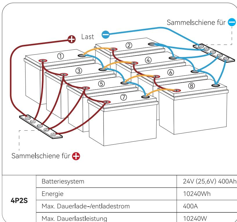
① Da **-** von ① / ③ / ⑤ / ⑦ in Reihe mit **+** von ② / ④ / ⑥ / ⑧ verbunden ist, bitte verbinden Sie nicht **-** von ① / ③ / ⑤ / ⑦ mit **-** der Last oder **+** von ② / ④ / ⑥ / ⑧ mit **+** der Last, sonst wird das Batteriesystem nicht in Reihe geschaltet.
