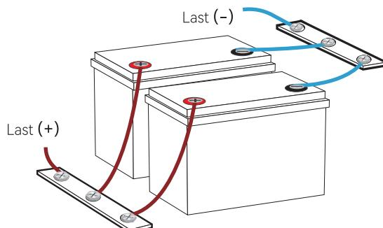
Nach der Parallelschaltung wird sich die **Kapazität** des Batteriesystems entsprechend der Anzahl der angeschlossenen Batterien verdoppelt.
