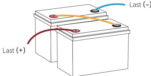
Nach der Reihenschaltung wird sich die **Spannung** des Batteriesystems entsprechend der Anzahl der angeschlossenen Batterien verdoppelt.
